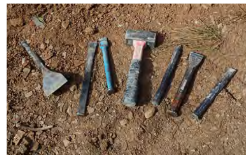
Eines per al tall de la pedra. D'esquerra a dreta, tallapedra d'acer, escarpa d'acer, gradina d'acer, massa o maceta, punxó de vídia, topo (o escafilador) de vídia i escarpa de vídia.
